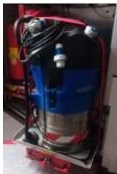
Der Sauger ermöglicht eine schnelle und effiziente Reinigung bei Schmutzwassereinsätzen mit geringem Wasserstand. Das Wasser wird zuerst in einem Behälter gespeichert und bei Bedarf abgepumpt.
