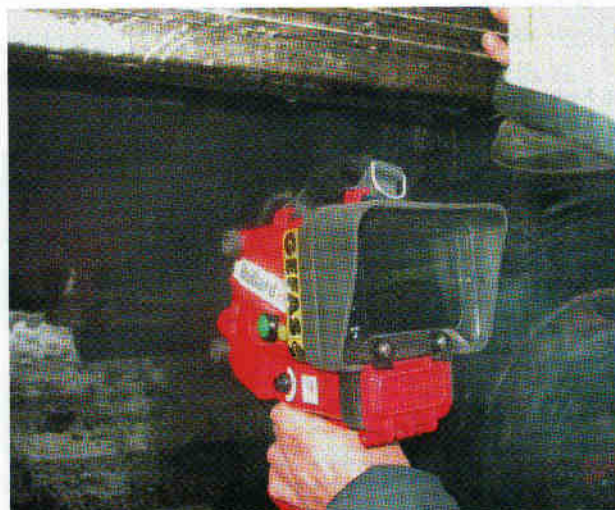
Die Wärmebildkamera im Einsatz beim LKW-Brand am 26. Dezember 2003 in Pertisau: Kontrolle des Motorraumes nach Abschluss der Löscharbeiten.
